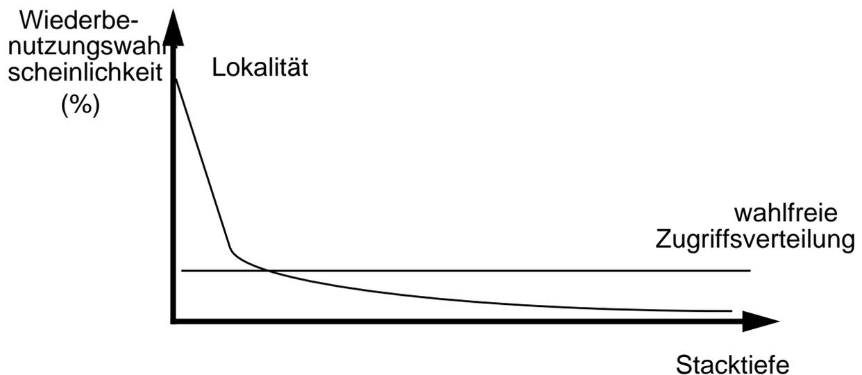
Für LRU-Seitenersetzung kann aus der Stacktiefenverteilung für eine bestimmte Puffergröße unmittelbar die Trefferrate (bzw. Fehlseitenrate) bestimmt werden
