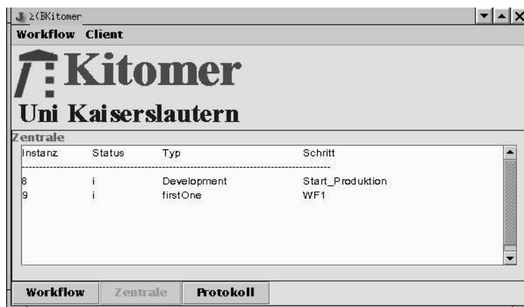
Abbildung 5 einfaches Monitoring der in Ausführung befindlichen Workflows
